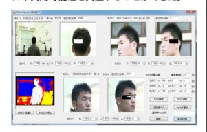
図は,自律型表情モニタリングシステムのアプリケーションウィンドウで,被験者を囲むように配置した3台のネットワークカメラのうち,画像処理によって背面と認識したカメラはズームアウトして周辺状況を録テするとともに,前面の2台は顔の表情をステレオ画像として撮影し,静止画(JPEG)を設定された時間間隔で保存することができるようになっている。
