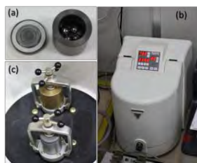
図3 遊星ボールミル装置；(b) (FRITSHE製 Puluerisette P-6) および粉碎容器；(a), 遊星回転台；(c)。
