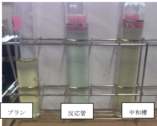
Fig. 8 流通系吸光度(石英砂 0.50 g, \text{N}_2 :0.9 ml/min)
