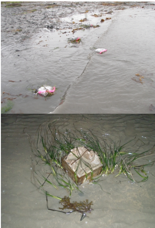
図 3. アマモ場での地下部の非破壊的画像観測のために設置されたアクリルボックス
