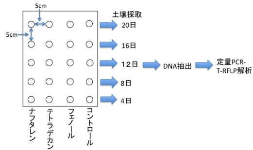
埋設した鏃の周辺土壤を一定期間ごとに採取した。採取方法としては、底をくりぬいた50mlのディスポチューブを土壤に挿して、鏃を中心として周囲0.7cmまでの均一な距離の土壤を採取することとした。(次図)。
