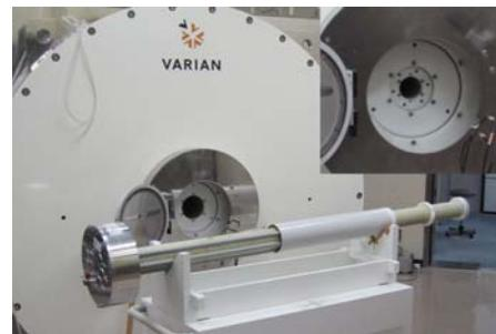
図 1 7T MR 装置と傾斜磁場コイル。3 種類の内径の傾斜磁場コイルを選択できる（右上）
