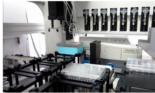
図1: 自動培養システムの外観。クリーンベンチ内に設置した分注ロボットに、インキュベータとプレートリーダーを接続している。
