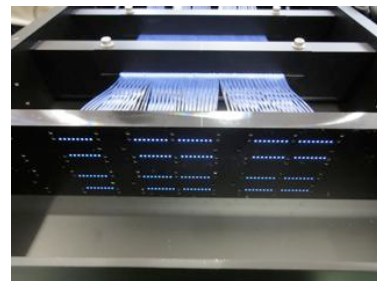
図 2: ビームラインファイバー検出器 (BFT) の写真。ファイバーの読み出し方向から見たものであり、この端面に MPPC 基板を接続することによってファイバーからの光を検出する。
