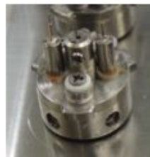
図1 建設した超高真空、強磁場印可能な低温走査トンネルポテンシオメトリ測定装置。
