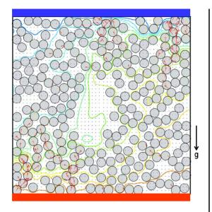
一対の回転流れを示す。そのときの瞬時の流れ場の一例を上図に示す。この図では粒子と粒子の間は流体で満たされており、流体と粒子の間に分布する等温度線とともに、接触した粒子間の接触熱流束を矢印で示している。
