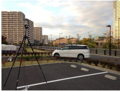
図12 LiDARによる車両認識・制御の様子
