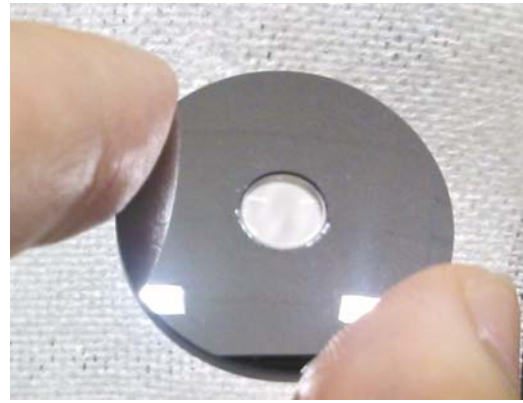
図5 シリコン-ガラスハイブリッドレンズの写真。機械加工したシリコンレンズの中央の穴にガラスレンズをはめ込んだ。
