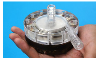
図 8 試作したベアリングレスポンプ
