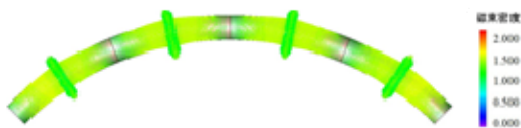
図8 円弧形シャフトモーター二号機の電磁界解析結果
