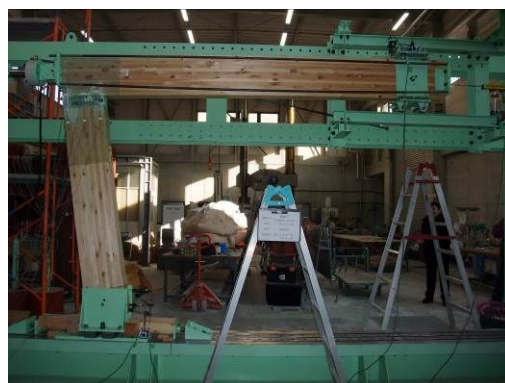
写真 3 L 型試験体 (FRP 有) の終局状況
