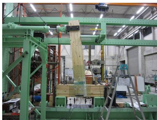
写真 2 T 型試験体 (FRP 有) の終局状況
