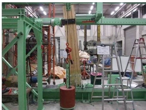
写真 1 I 型試験体 (FRP 有) の終局状況
