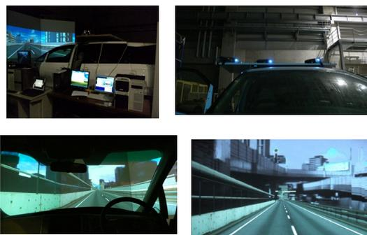
図 5 : (上) 定置型実写映像合成 DS 環境 (下) 合成出力例
