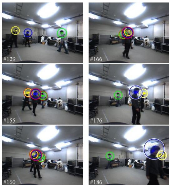
図5 重なりテンプレートを用いた複数人物追跡の例
