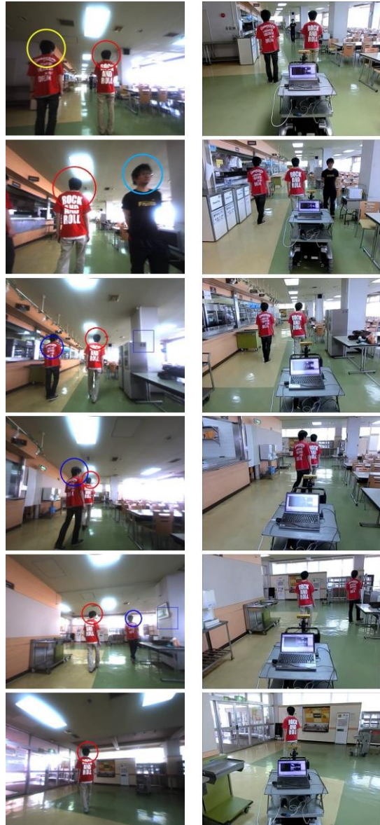
図6 移動ロボットによる特定人物追跡
