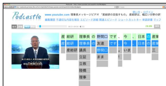
図 1 動画へ対応した PodCastle インターフェースの画面例：YouTube、ニコニコ動画、Ustream といった主要な動画共有サービスのコンテンツの全文検索・閲覧・編集(音声認識結果の訂正)が可能。
