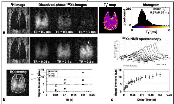
図 3. a: 溶解相  $^{129}$ Xe 画像の TE 依存性、 $T_2$ \*マップとヒストグラム、b: 溶解相  $^{129}$ Xe 画像の TR 依存性(Xe uptake 動態)、c: 溶解相  $^{129}$ Xe MRS による回復動態(Xe uptake 動態)
