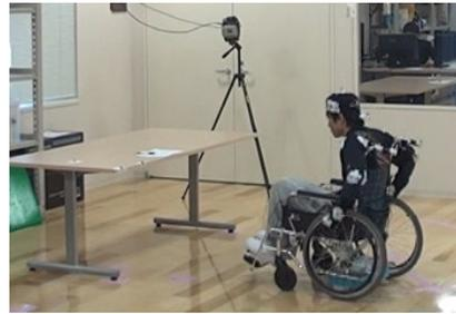
図 8 手動車椅子利用者による対象物へのアプローチの実験
