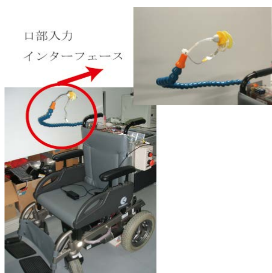
図 8 口部入力インターフェースの電動車椅子への実装
