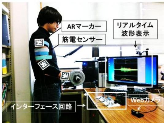
図1 表面筋電位計測システム
