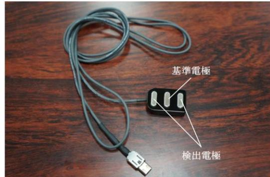
図3 筋電位センサー
