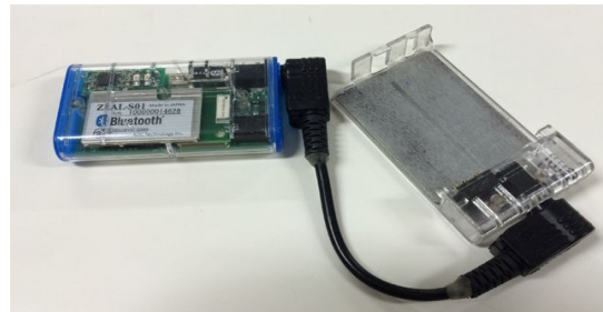
図 8 本件課題で開発したセンサ右側がバッテリーボックス。センサ本体と接続するコードは脱着式
