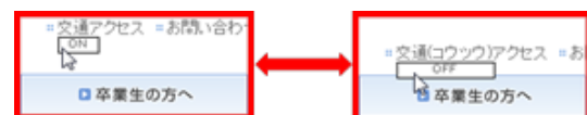
図1 読み切り替えスイッチ（スイッチを押すことで読みの表示・非表示を切り替える）
