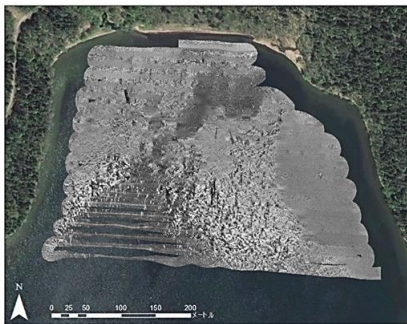
図2 モザイク処理を施した後方散乱強度画の例(チュウレイ湾2012年7月)。
