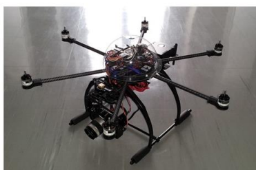
図7 空中写真取得用に製作したマルチコプター。
