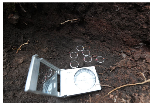
図 1 古地磁気測定用定方位試料サンプリングの様子。
