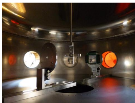
図2. 実験のセットアップ。左方向から ^{30}\text{Mg} ビームが入射し、真中にある標的に照射される。反跳陽子のエネルギーを右に置いたシリコン検出器群で測定する。
