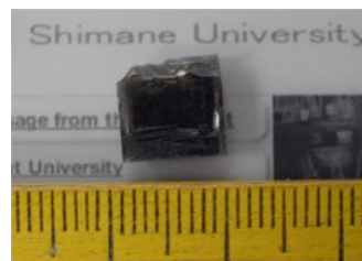
図 2. 還元された Ni 添加 \text{KTaO}_3 結晶. Ni を添加するごとに黒色部分が増え、1 mol% の添加で、ほとんどが黒色となった。
