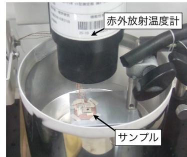
図1：赤外放射温度計を利用した試料温度評価手法。サンプルの電気抵抗をいくつか異なる電流値で測定し試料温度をサンプル上の放射温度計で計測する。
