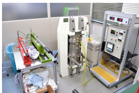
図 2 . ピストンシリンダー型高温高压発生装置（PG-100）。
