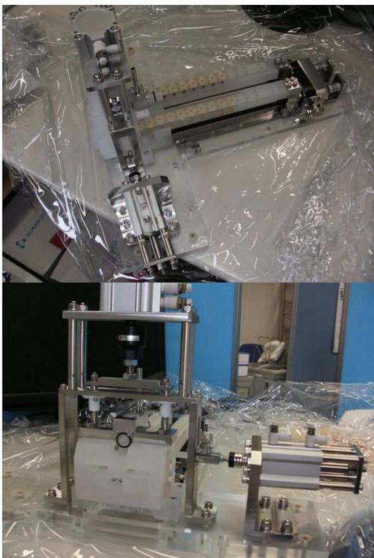
図 2. 開発した迅速電気化学クロマトグラフ装置の写真。
