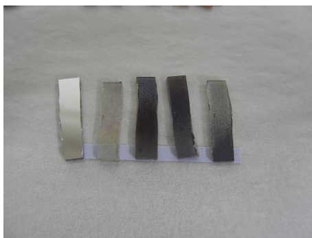
図1 硫化処理により作製したSnS薄膜 (左からSn薄膜、硫化温度100, 200, 300, 400 )
