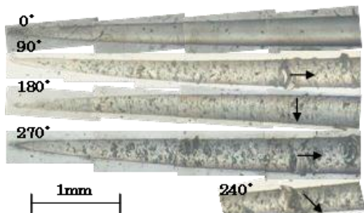
図5 切込みを連続的に変化させた時の加工溝
