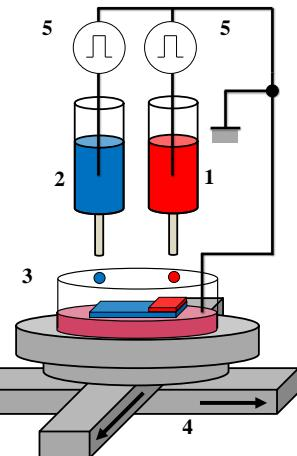
図-1 静電マイクロドロップ・インジェクション装置（加圧ユニット付）
