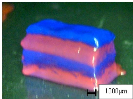
図-2 静電マイクロドロップ・インジェクション装置の繰り返し描画による積層
