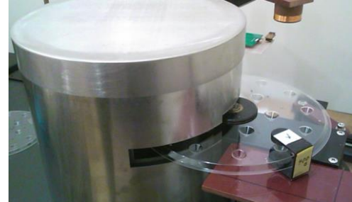
図5 磁気シールドボックス内に設置したMRセンサを用いた磁氣的免疫検査システム
