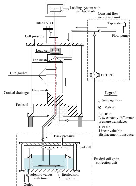
図1:新たに開発した三軸試験装置の概要
