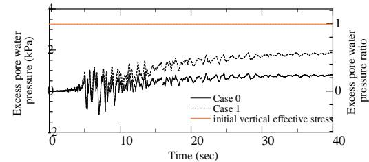
図4：法尻部における過剰間隙水圧の時刻歴
