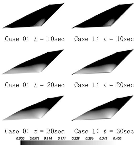
図3：過剰間隙水圧比分布の時間変化
