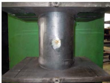
写真2 最終破壊状況
