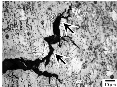
図2: Mg-Y合金の代表的なき裂進展観察例上図では、き裂進展経路を明瞭にするため、平均結晶粒径:10 $\mu\text{m}$ からなる試料(熱処理により調整)を使用
