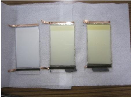
図6 紫外線照射試験後のデバイス
