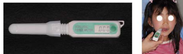
Fig.5 最大咬合力測定器
