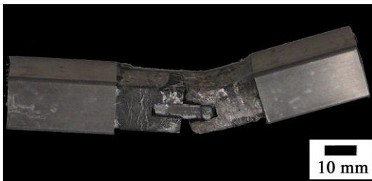
図 12 4点曲げ試験後の発泡接合体の外観写真.
