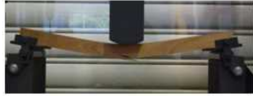
写真2 曲げ試験の様子
