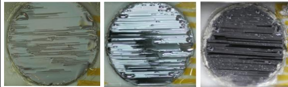
H=360nm H=1700nm H=1000nm 疎水面, 親水面 疎水面のみ
