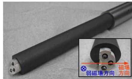
図5 新規製作した3芯プローブヘッド
