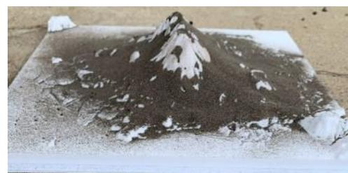
図4 降灰堆積の様子(0.12[mm]積層)
