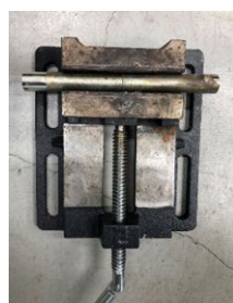
図 4 ろう付する材料をバイスで固定
