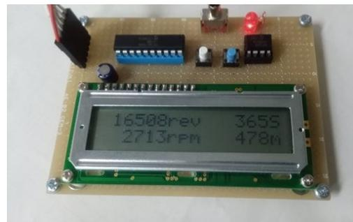
図4 回転数・回転速度・距離 表示装置
