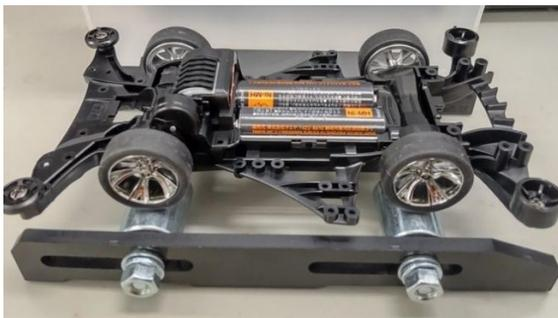
図3 回転数計測装置(計測はケースで困って行く)
