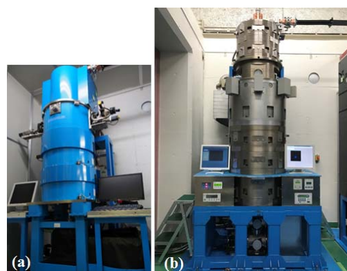
Fig.4 RF 電子銃搭載時間分解電子顕微鏡の試験機(a)と実証機(b)の写真
