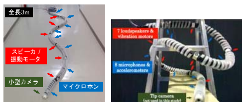
索状ロボットの概要と 3D 姿勢推定実験
