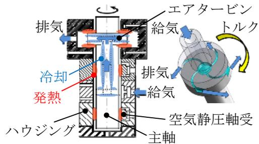
図3 熱変形抑制スピンドル系
