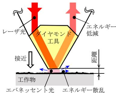
図4 エバネッセント光応用接触検知
